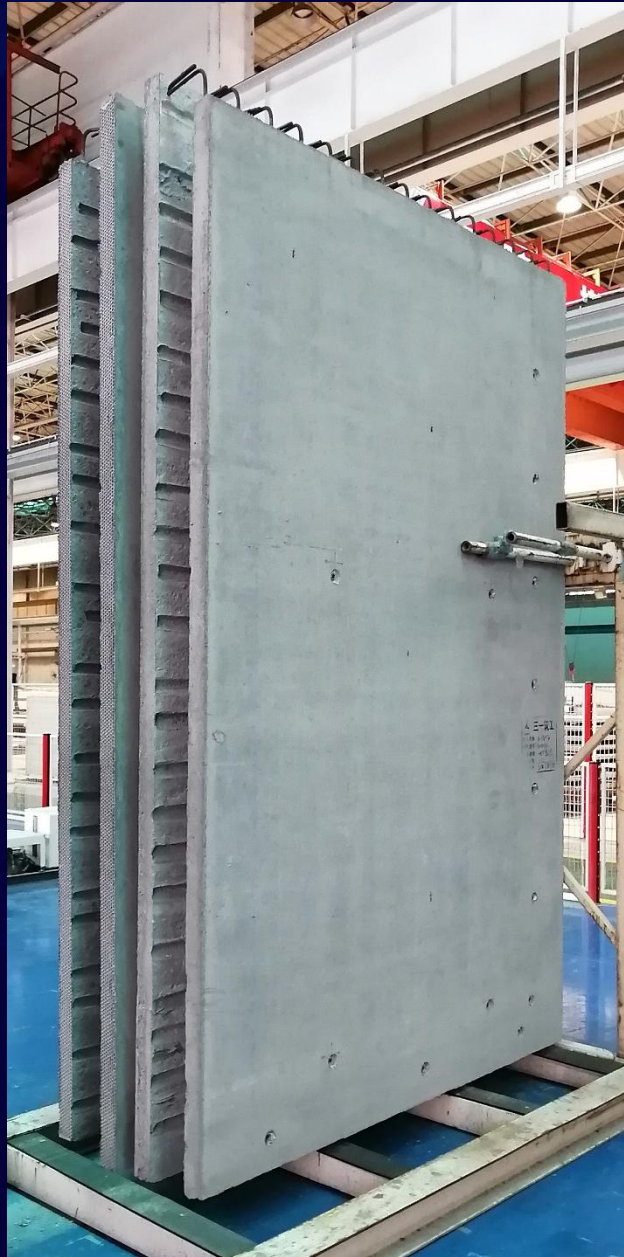
地下室外墙构件
